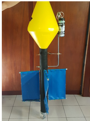
Afbeelding 17: Boei met dwarse verhooging GPS-koker
