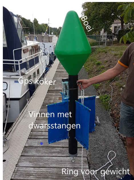
Afbeelding 14: eerste ontwerp meetboei
