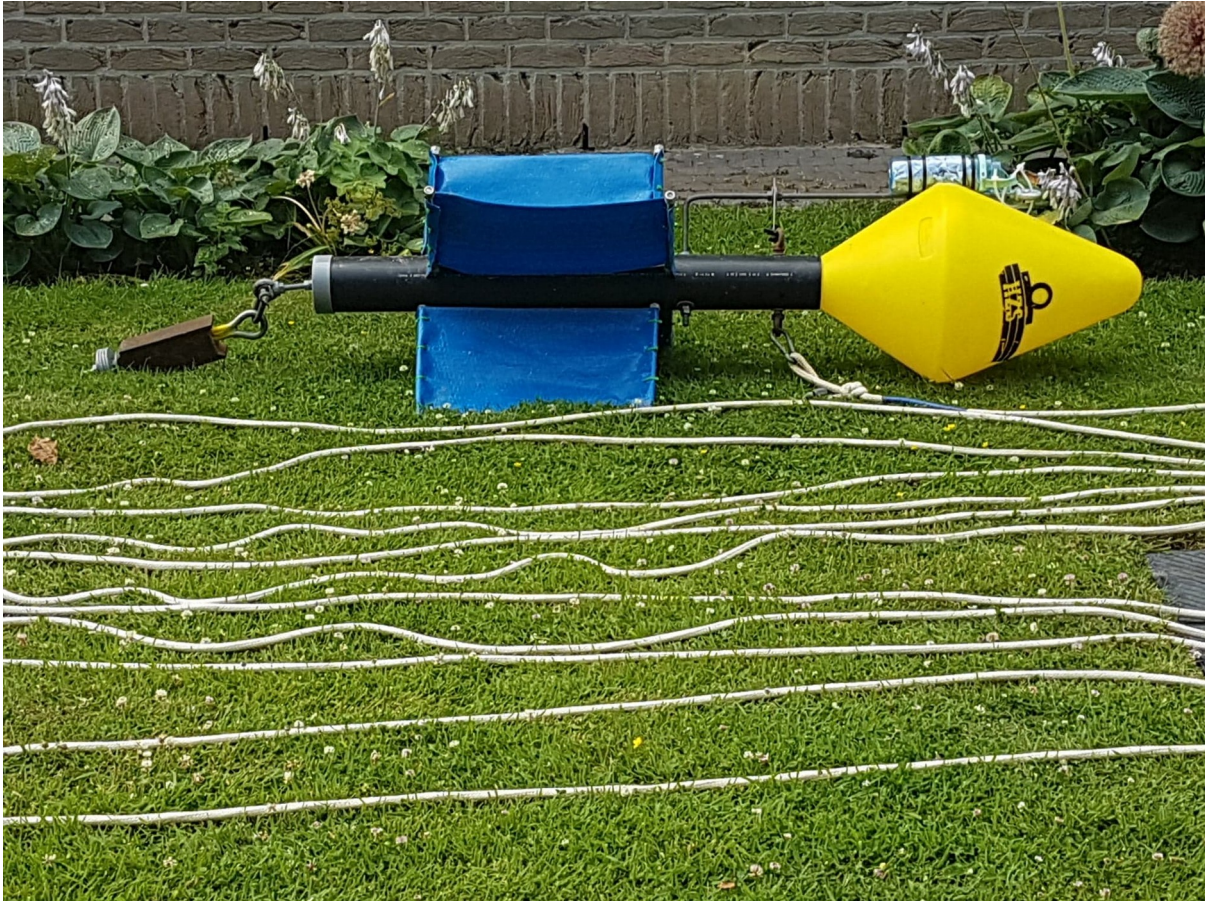
Afbeelding 18: Eindproduct: boei met GPS-koker en gewicht
