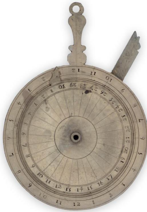
Figuur 38 Een Duits nocturlabium uit de 16 de eeuw.
