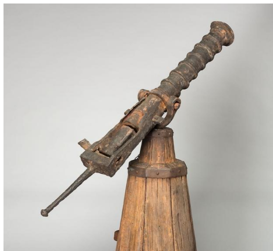
Figuur 30 Een ijzeren falconet uit de 16 de eeuw. De lader voor het buskruit achteraan is duidelijk zichtbaar.
