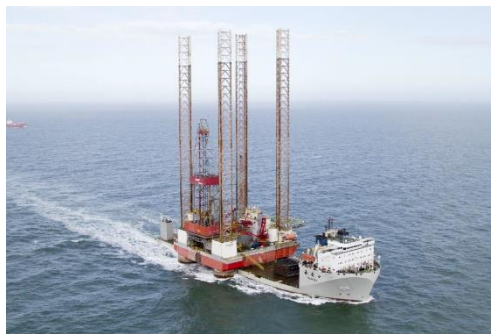
Figuur 4: Zelfheffend platform verplaatst door half-afzinkbaar schip
