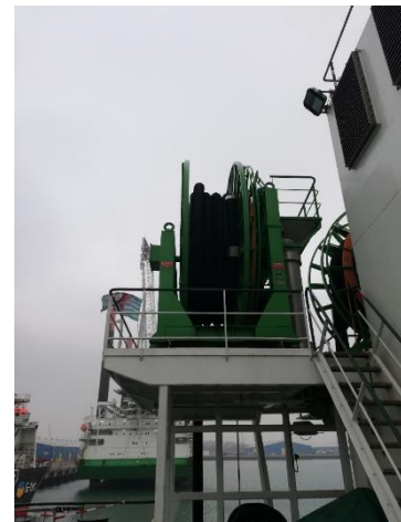
Figuur 7: Aanzuiging van het koelwater aan boord van de Neptune
