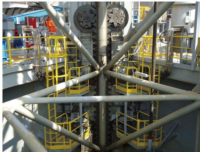
Figuur 13: Zelfheffende structuur met tandheugelsysteem
