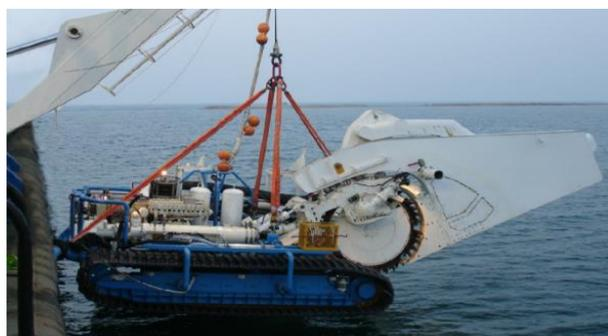
Figure 8 Ensouilleuse à roue trancheuse
