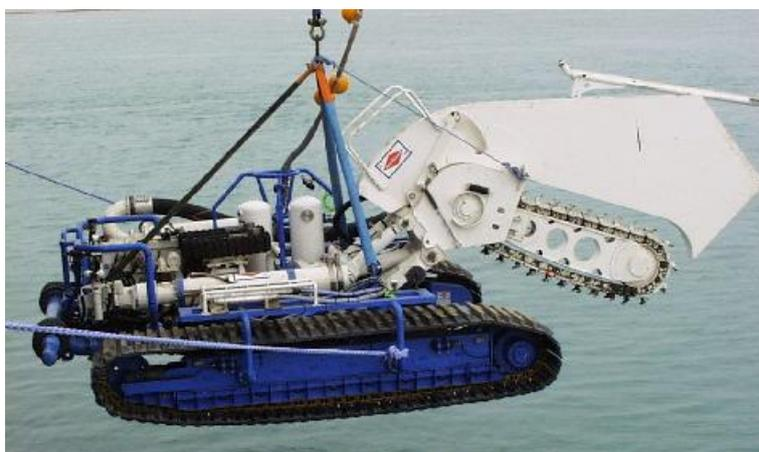
Figure 9 Ensouilleuse à chaîne excavatrice
