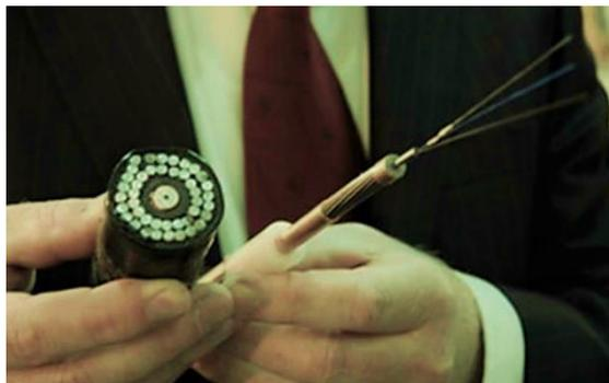
Figure 12 Câble de fibre optique
