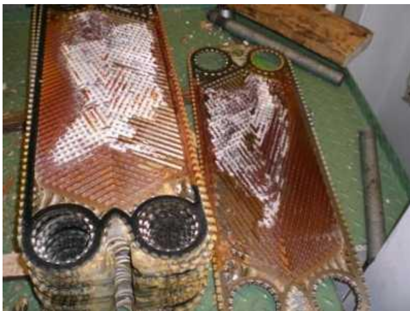
Figuur 8 Geoxideerde en verstopte platen uit een warmtewisselaar
