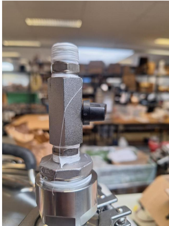
Figuur 30: adapter+vernauwing 3/8 + afsluiter 3/8
