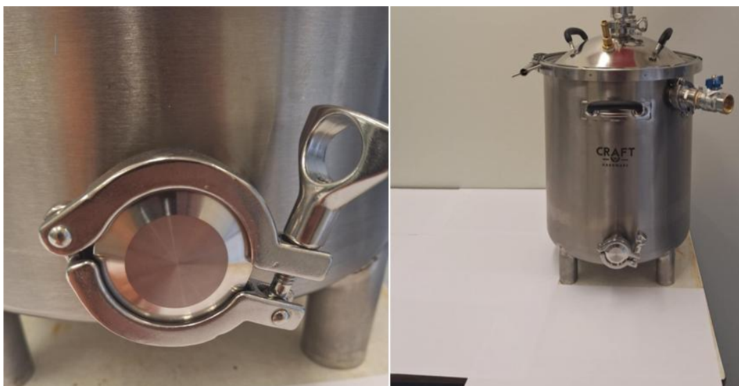
Figuur 27: blindstop en gemonteerd op het vat+ vast op statief
