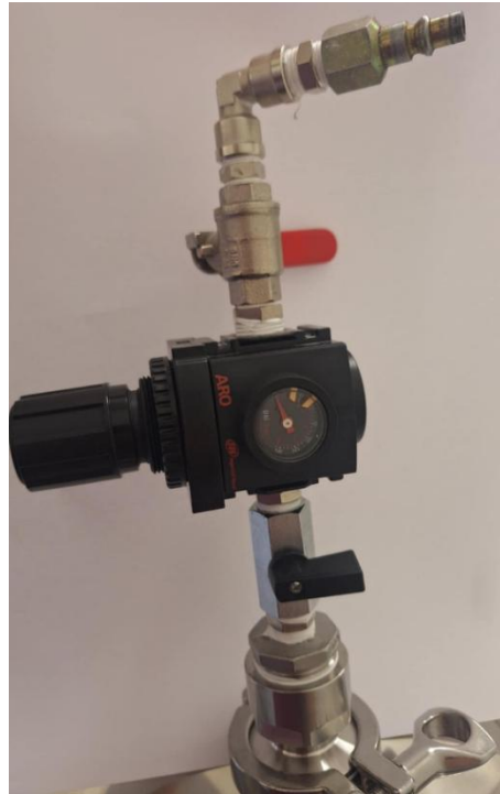
Figuur 32: perslucht opstelling volledig gemonteerd
