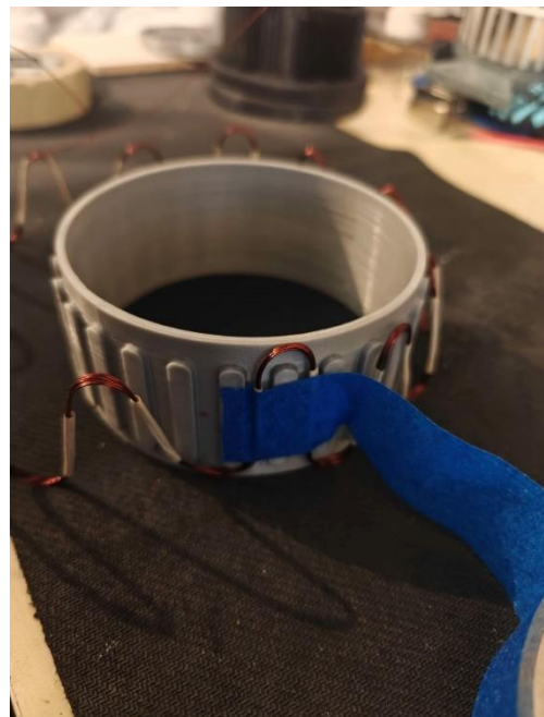
Figuur 31 Vastplakken lus op statorring
