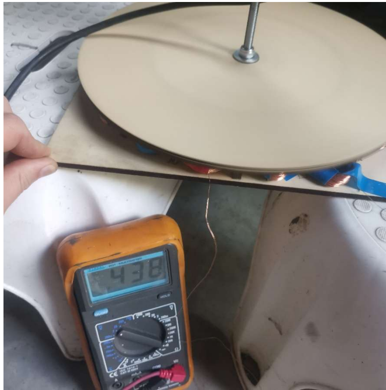
Figuur 49: Test met verbeterde wikkeling, Bron: eigen werk
