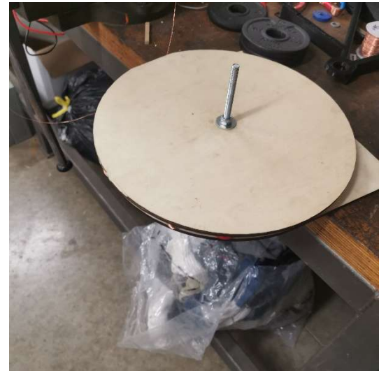
Figuur 51: Testopstelling met 36 magneten en verkleinde spoel, Bron: eigen werk
