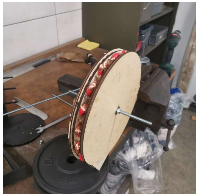
Figuur 47: Constructie van de generator, Bron: eigen werk
