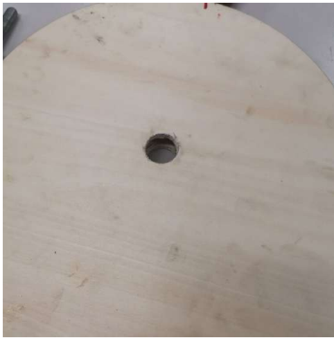
Figuur 46: Vergroten centergat stator, Bron: eigen werk
