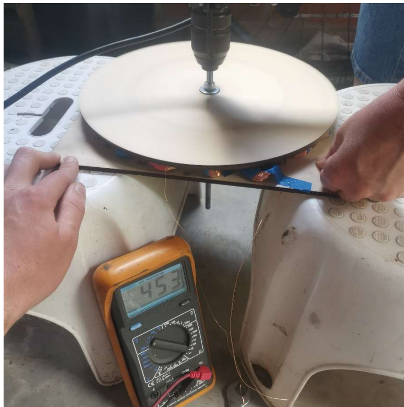
Figuur 50: Testopstelling met verkleinde luchtspleet, Bron: eigen werk
