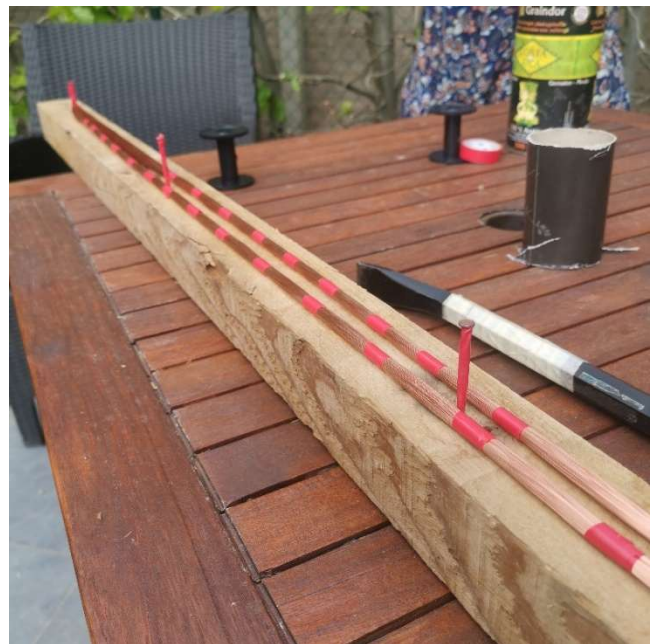
Figuur 41: Spoel wikkel constructie, Bron: eigen werk
