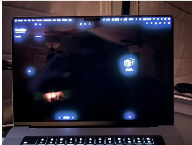
Figuur 16 Blooming effect op LED LCD scherm Bron: Adamjackson
