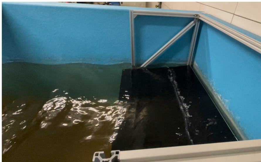
Figuur 56 Inkomende golven breken op de helling
