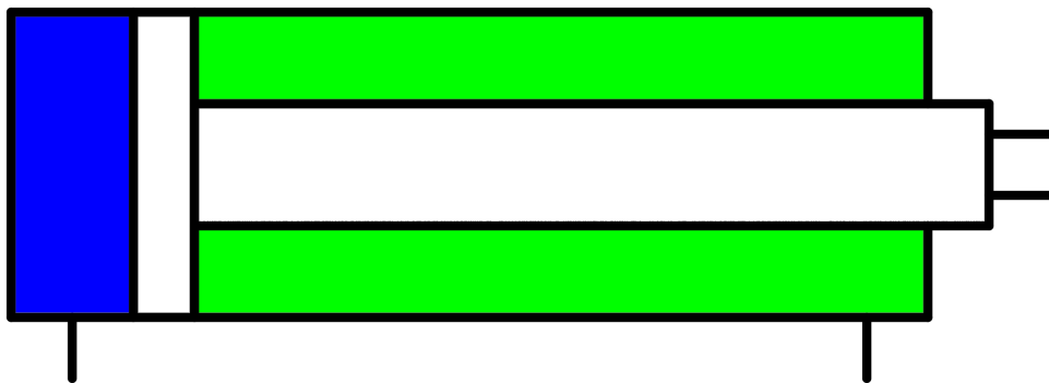
Figuur 24 Illustratie volumes pneumatische cilinder
