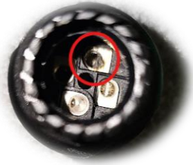
Figuur 55: Brandplek in de rode cirkel te zien aan de terminal van de voedingskabel wat op een eerdere kortsluiting kan wijzen.
