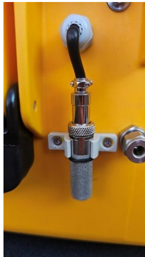
Figuur 8: Bevestiging van de SHT30-sensor aan de buitenkant van de meetkoffer voor omgevingsmetingen.
