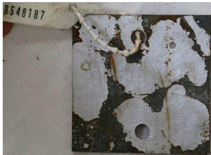
Figuur 10 Voorkant van coupon R548187 na afspoelen onder hoge druk
