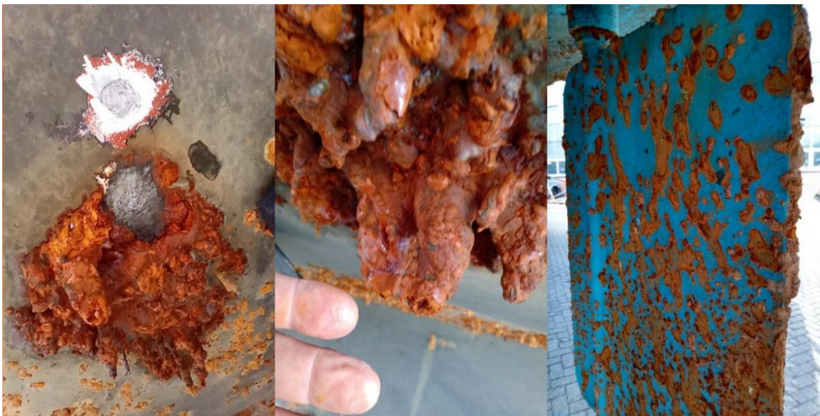
Figuur 1 Tuberkelvorming op romp Theodora IV
