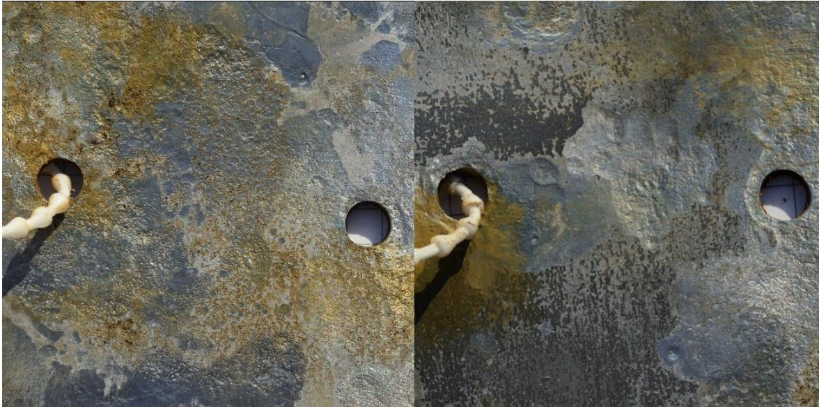
Figuur 15 Vershil in pitting tussen een niet geëtste coupon (links) en een geëtste coupon (rechts)
