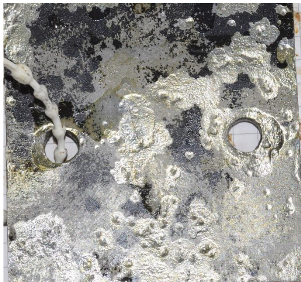
Figuur 17 Aantasting op een coupon na 6 maanden blootstelling aan het kanaalwater
