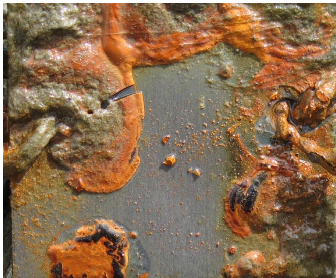
Figuur 23 Oranje slijmlaag na 3 maanden
