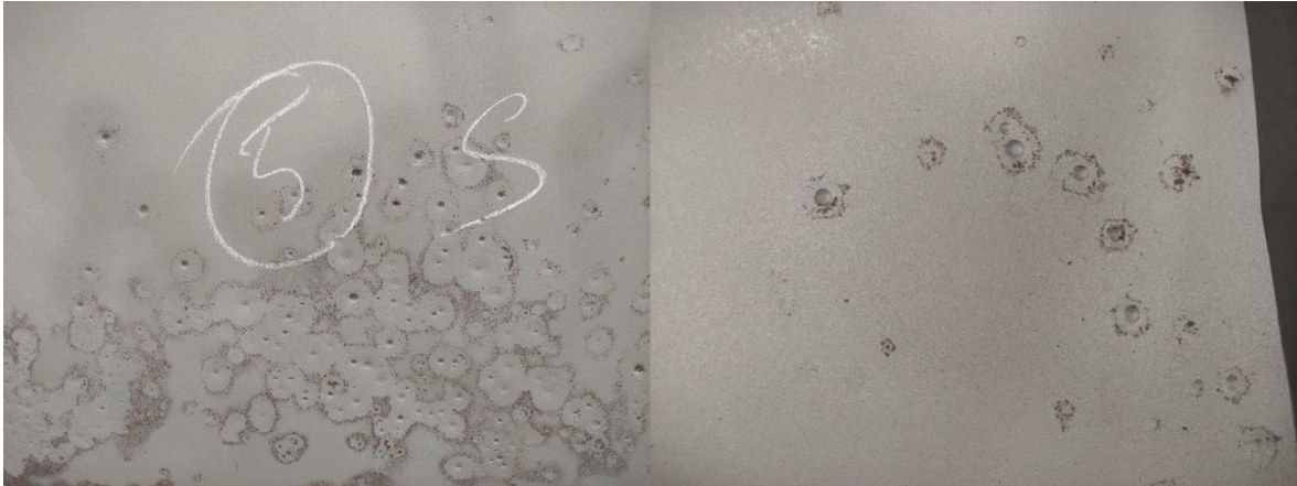
Figuur 14 Vergelijking corrosiepatroon op de romp (links) met corrosiepatroon op de spiegel (rechts)
