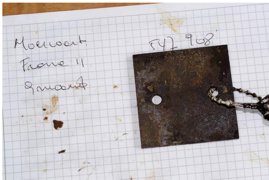
Figuur 20 Coupon zonder sporen van pitting (moervaart)
