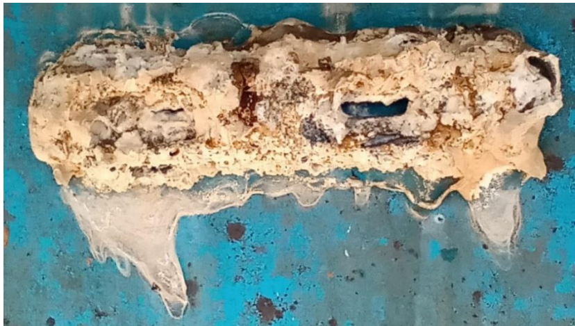
Figuur 12 Aluminium anode Theodora IV
