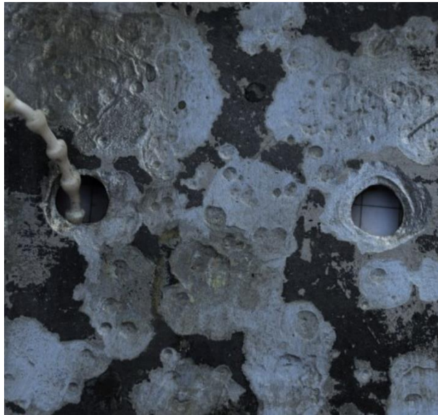
Figuur 16 Aantasting op een coupon na 3 maanden blootstelling
