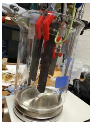
Figuur 39 Opstelling van drie elektrode testcel in de Bredastraat als voorbereidend werk
