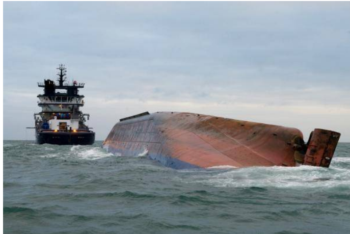
Figure 37 Remorquage navire avec mauvaise navigabilité
