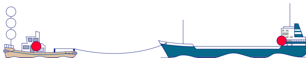
Figure 40 Feux Bâbord d'un navire remorqué
