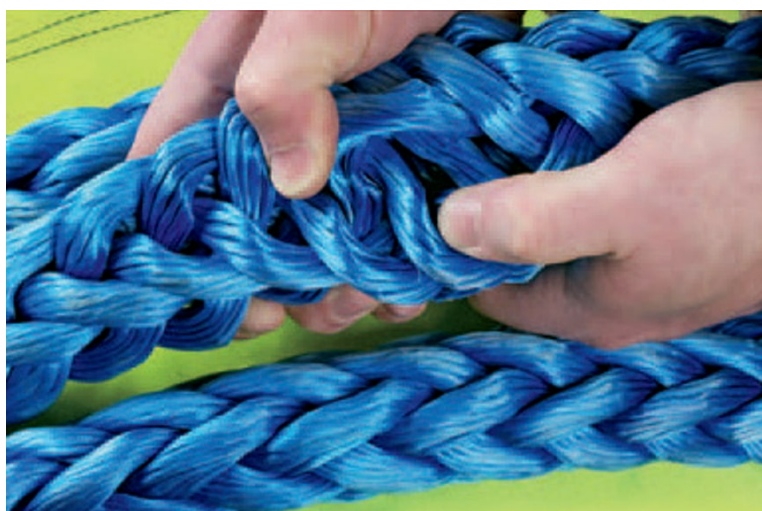
Figure 35 Inspection ligne synthétique
