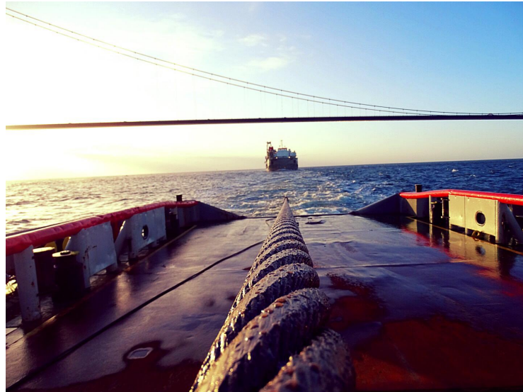
Figure 25 Remorque principale sous tension
