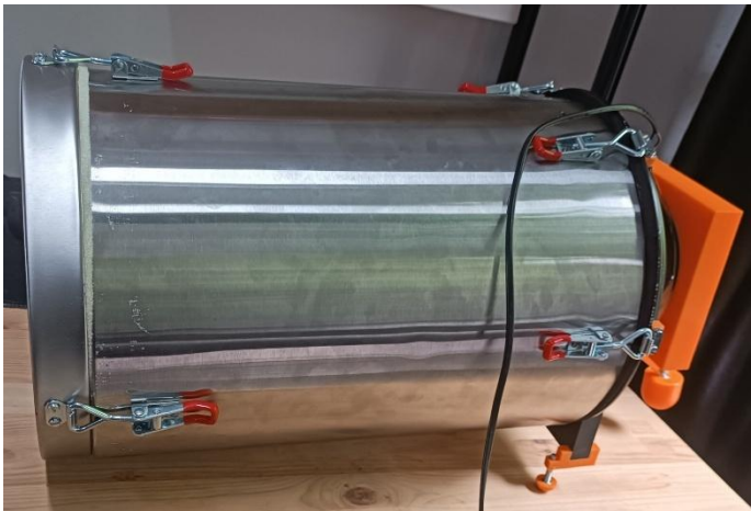
Figure 41 Canon concentrateur d'ondes - intérieur et extérieur
