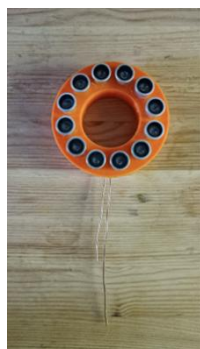
Figure 43: Module avec transducteurs ultrasonique
