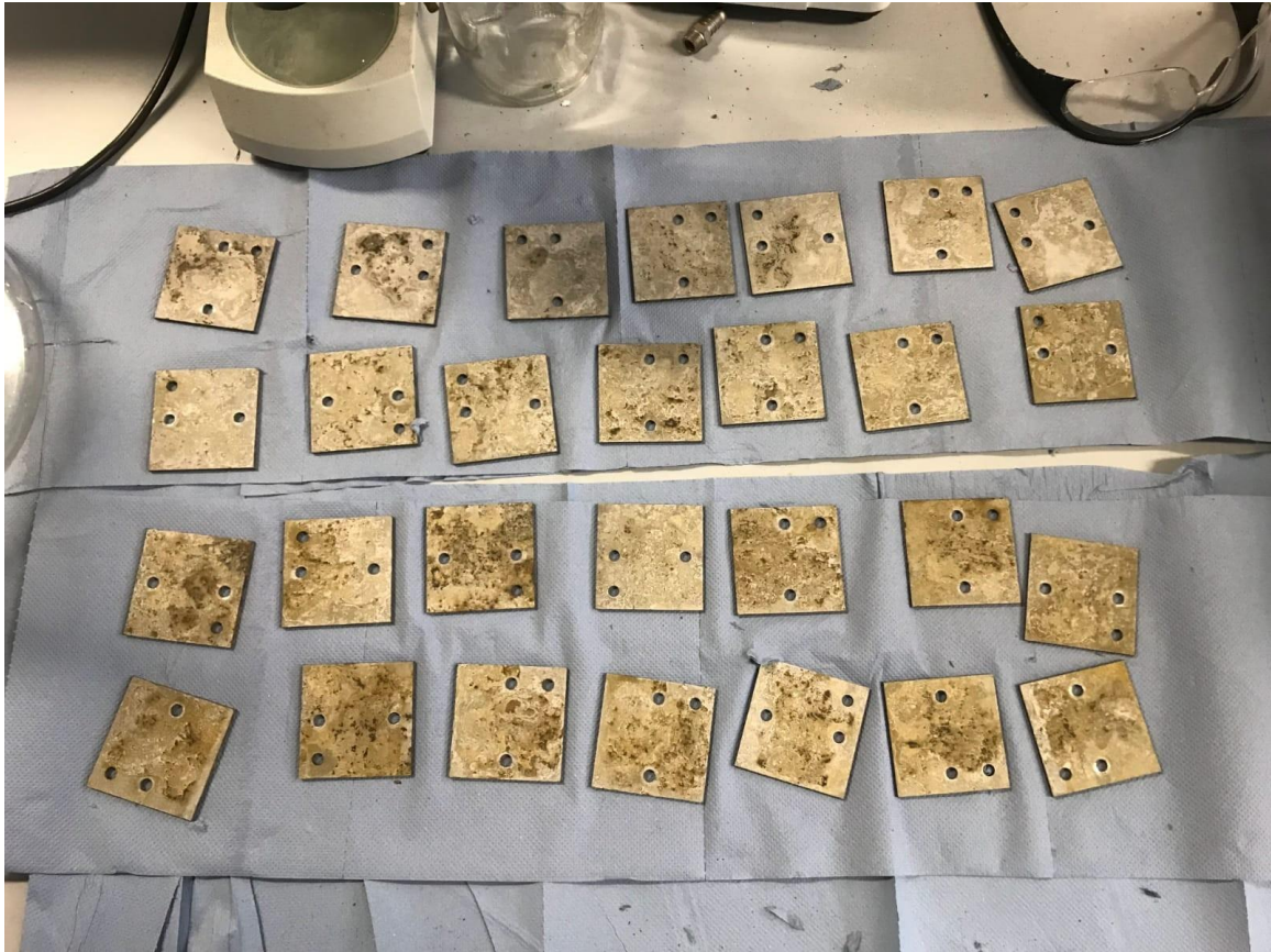
Figuur 17 Coupons na blootstelling aan Clark-oplossing
