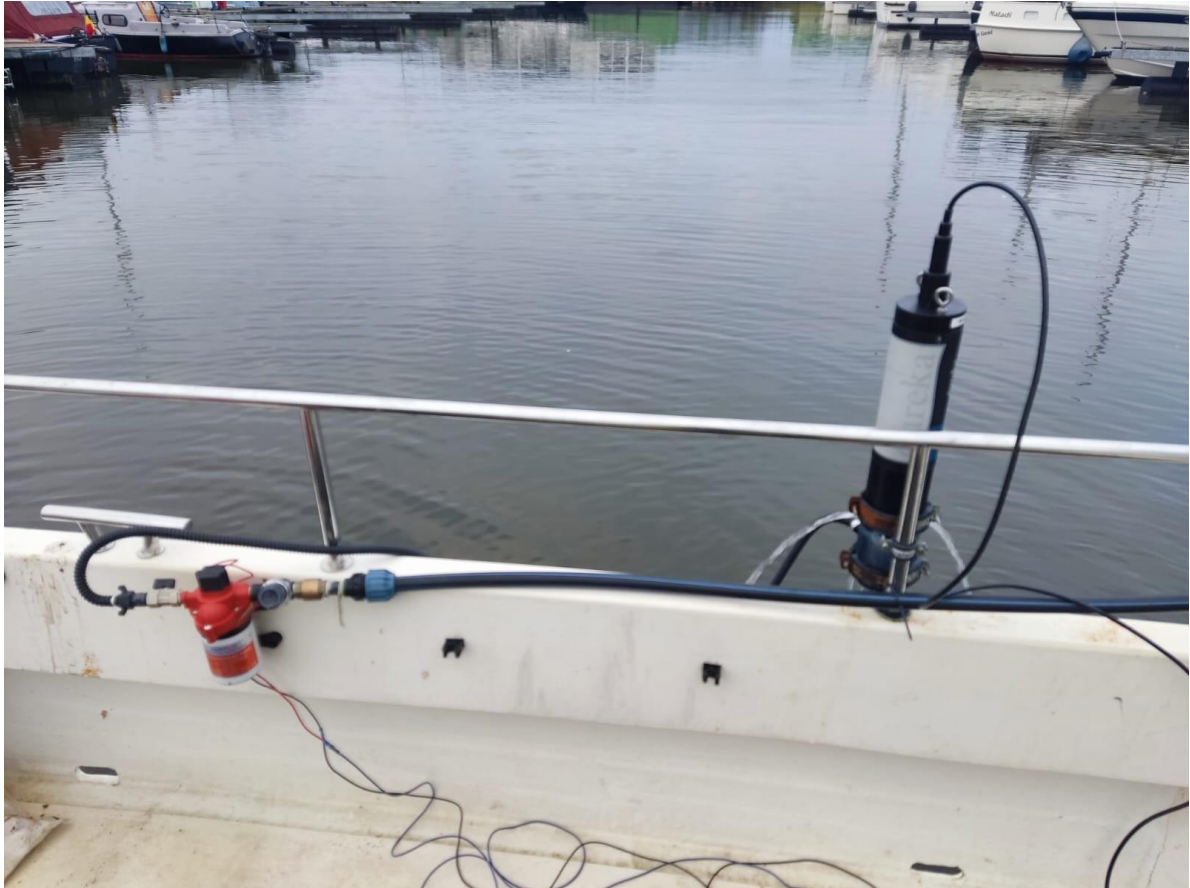
Figuur 11 Manta 35 – multisensorprobe
