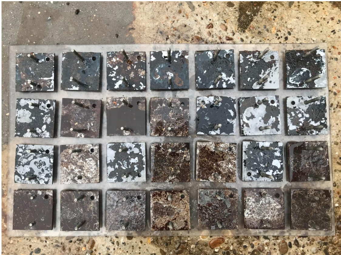
Figuur 15 Coupons na hogedrukreiniging
