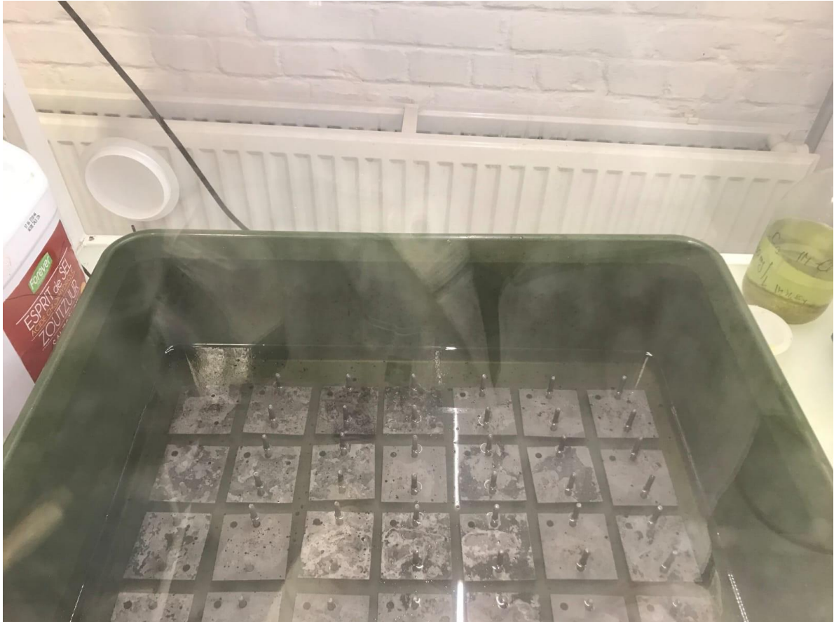
Figuur 16 Coupons tijdens blootstelling aan Clark-oplossing
