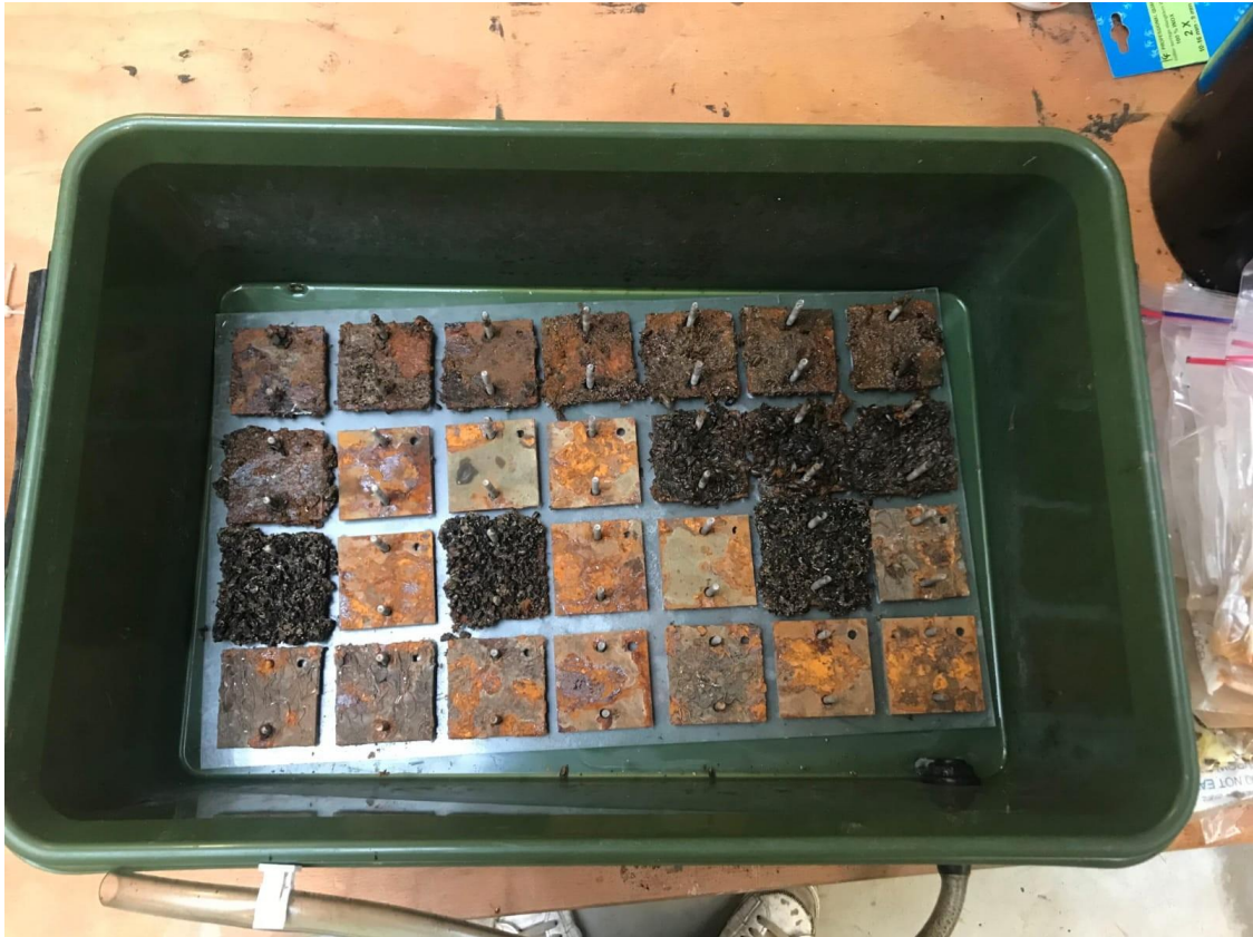
Figuur 14 Coupons met macrofouling
