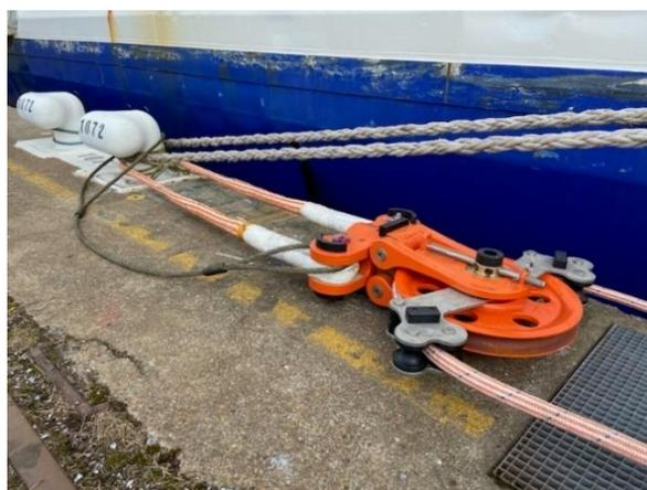
**Figure 17 : Poulie fixée au bollard de terre par une élingue en Dyneema, plus une élingue de sécurité en câble**
