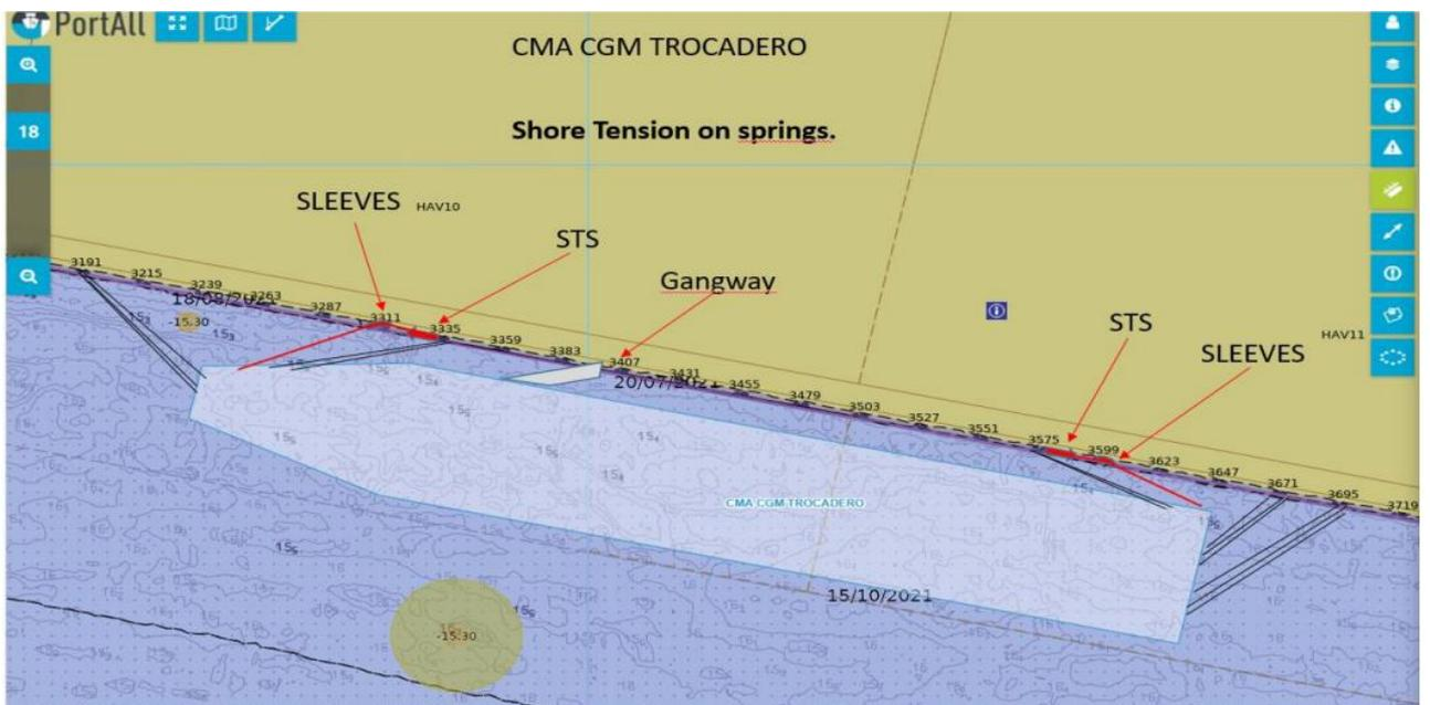
Mise en place sur STS sur le CMA CGM TROCADERO : Montage sur gardes avec sleeves.
