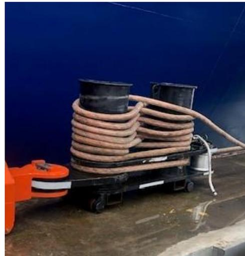
**Figure 14 : Double bitte d'amarrage fixé à l'extrémité du vérin sans et avec l'aussière de Dyneema**
