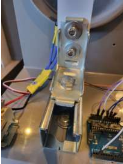
Figuur 26 Bevestiging van de motor op DIN rail Bron: Eigen werk
