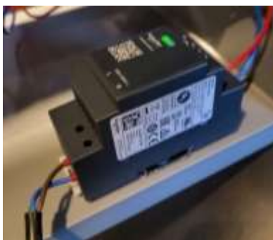
Figuur 34 230VAC/24VDC transformator Bron: Eigen werk
