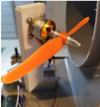
Figuur 25 Bevestiging van de motor Bron: Eigen werk
