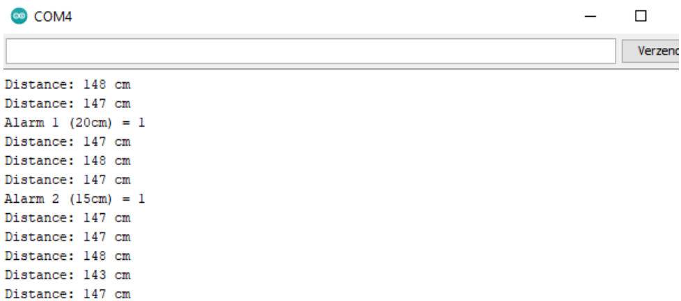
Afbeelding 52 seriële monitor echo met alarm
