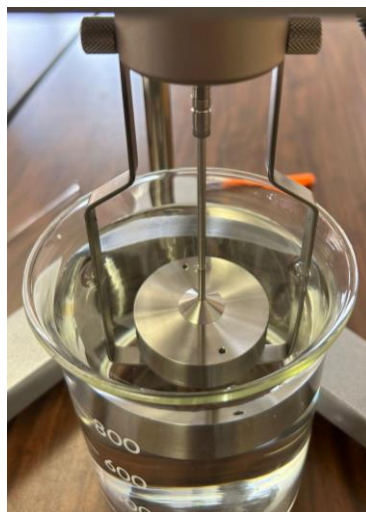
Figuur 20 Opstelling viscositeitsmeting Bron: Eigen werk
