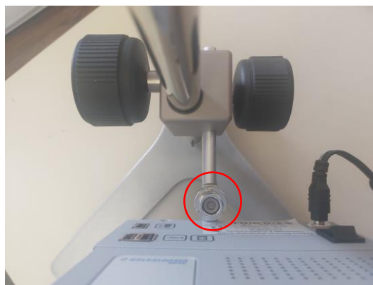
Figuur 16 HAAKE viscotester D waterpas Bron: Eigen werk
