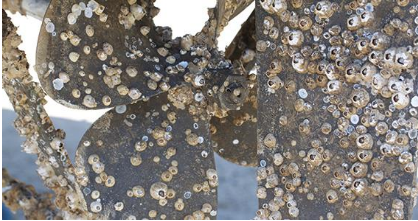
Figuur 7 Zeepokken op een roer en schroef van een schip
