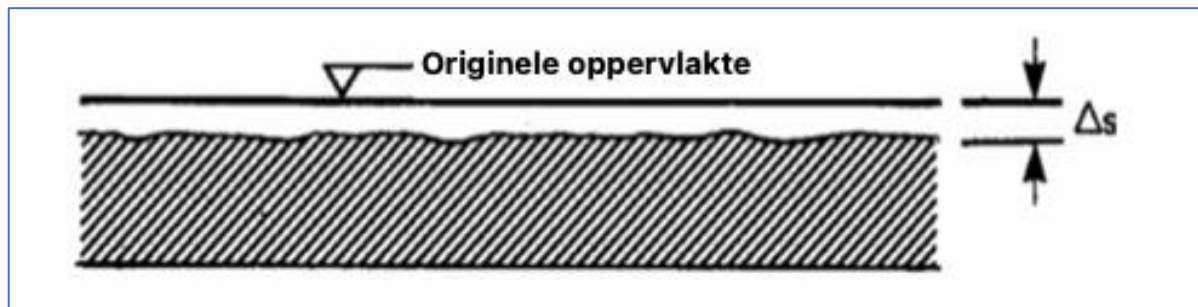
Figuur 5: Uniforme corrosie
