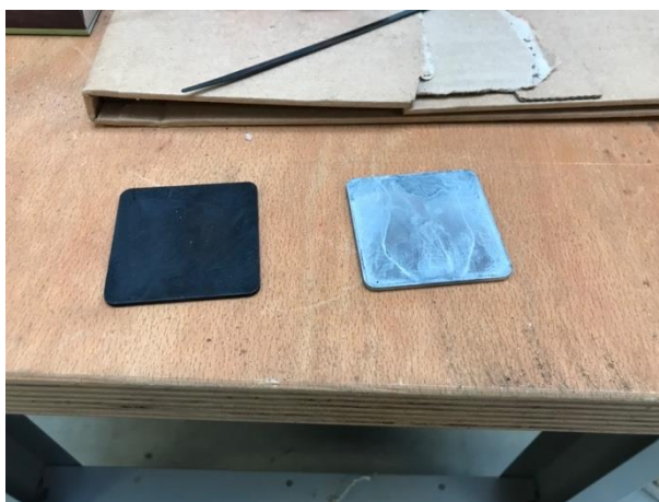
Figuur 20: zamaktestcoupon ondergedompeld in zoutzuur (links) versus een gewone zamaktestcoupon
