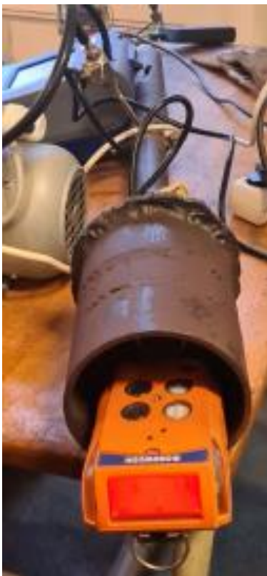
Figuur 5: NOx-concentratie meettoestel
