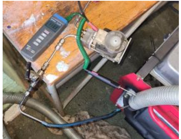
Figuur 3: Temperatuurscontrole + sample afname
