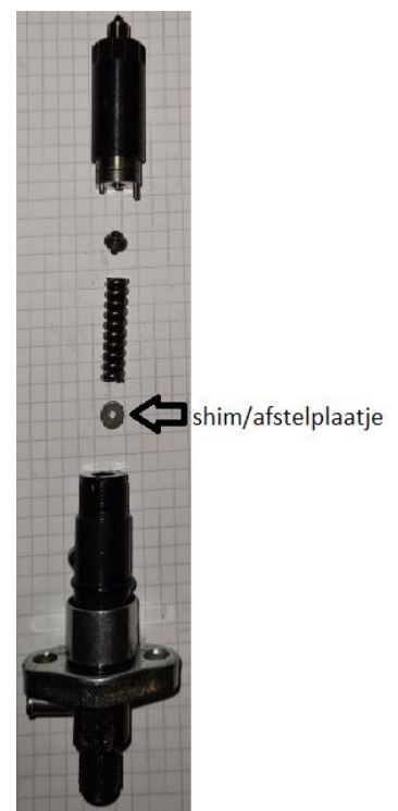
Figuur 10: Gedemonteerde injector
