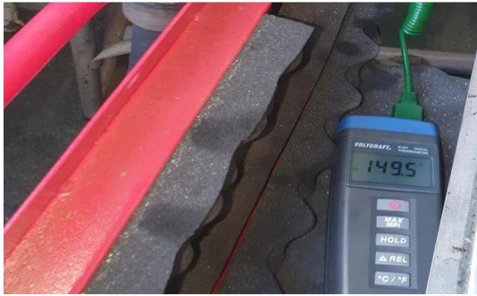
Figure 10 Appareil de mesure de température d'échappement
