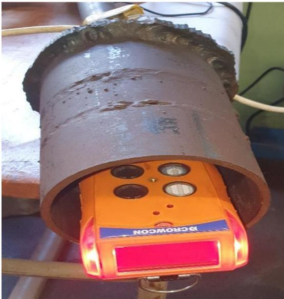
Figure 8 Appareil de mesure du NO et NO<sub>2</sub>
