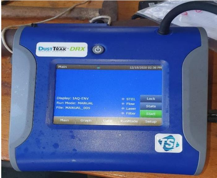
Figure 9 Appareil de mesure de particules PM
