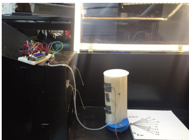
Figure 47 : Mesure micro manomètre
