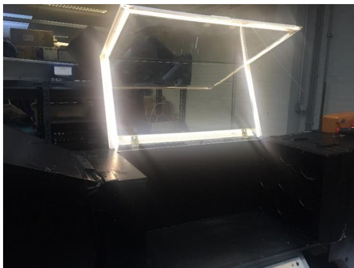
Figure 27 : Les Led dans la soufflerie
