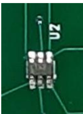
Figuur 39 Component gesoldeerd met soldeer pasta Bron: Eigen werk
