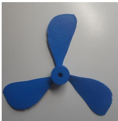
Figure 66 : Hélice 1 construite avec l'imprimante 3D
