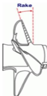
Figure 19 : Angle du rake
