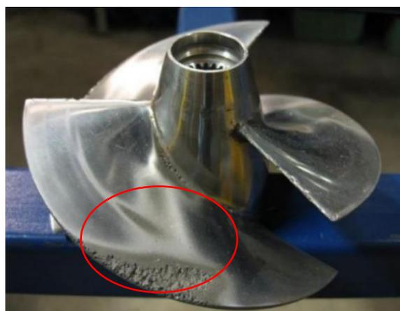
Figure 27 : Résultat de la cavitation sur une hélice en inox
