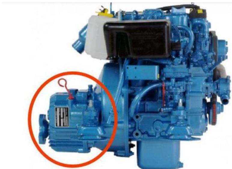
Figure 22 : Placement du réducteur sur un moteur
