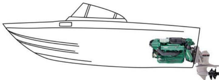
Figure 31 : Placement d'un azimuthal
