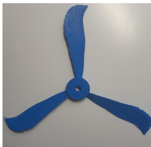
Figure 67 : Hélice 2 construite avec l'imprimante 3D
