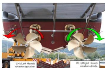
Figure 9 : Sens de rotation d'une hélice
