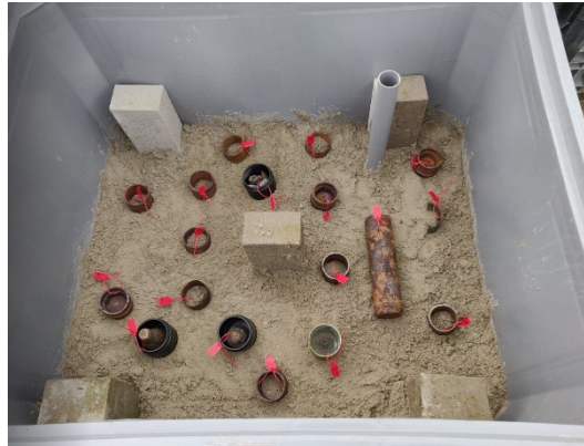
Figuur 31 Het testbassin met de granaatfragmenten en steunblokken
