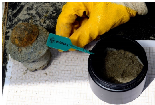
Figuur 58 Wegen en fotograferen van de ontstekers
