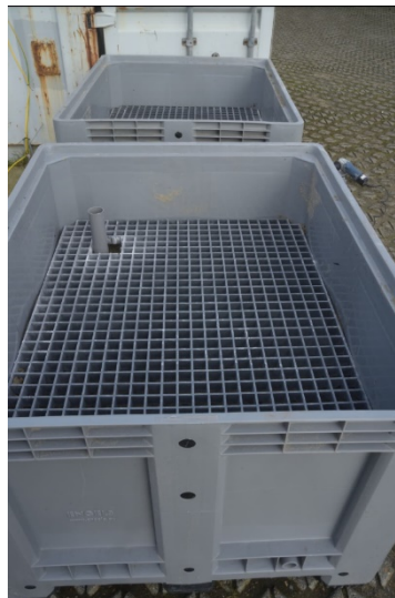
Figuur 32 Het testbassin met het plastic rooster en overflow
