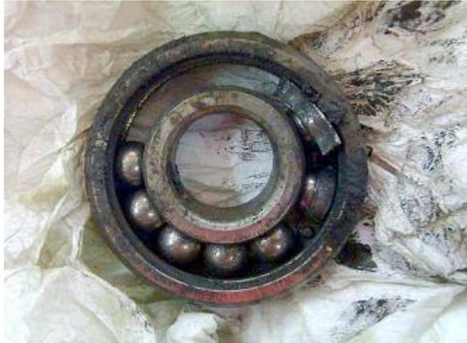
**Figure 14** Roulement standard endommagé <sup>14</sup>
