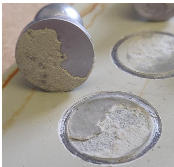
Figuur 34 Pull off test uitgevoerd op plaatje 982959 (Q-fog)
