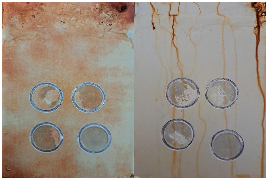
Figuur 35 Foto's na het afnemen van pull off test (onderdompeling 982478)(cyclisch drogen/vernevelen 982952)
