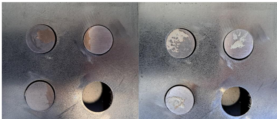
Figuur 36 Dolly's na pull off test (onderdompeling 982478) (cyclisch drogen/vernevelen 982952)
