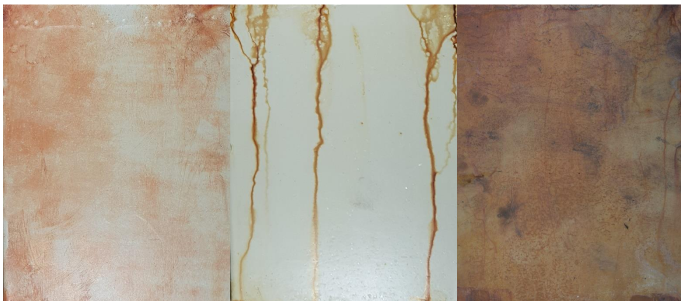
Figuur 49 Geverfde plaatjes na afloop testperiode (onderdompeling 982477, cyclisch drogen/vernevelen 982961, AMACORT CIFD – 01 982962)
