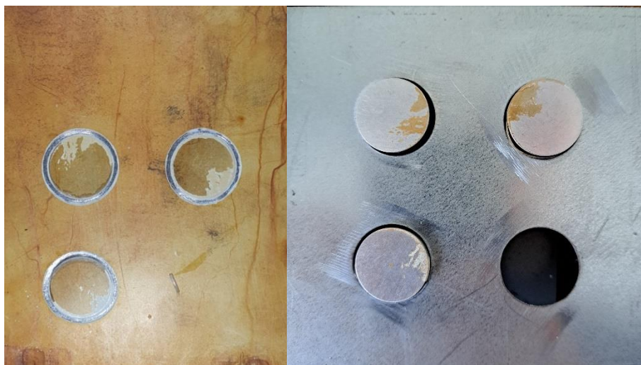
Figuur 43 Plaatje uit AMACORT C1FD – 01 en bijhorende dolly's na afnemen pull off test (982962)
