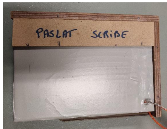
Figuur 23 Mal voor aanbrengen van kras
