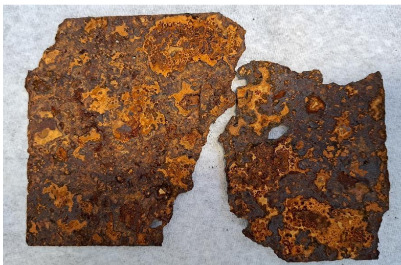
Figuur 47 Stukken corrosie afkomstig van plaatjes uit cyclisch drogen/vernevelen
