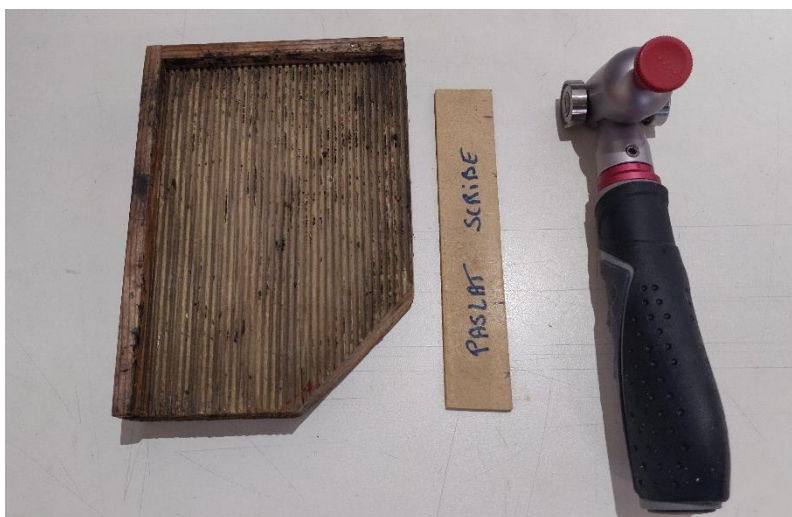
Figuur 15 Mal, houten lat en gebruikte krastoestel
