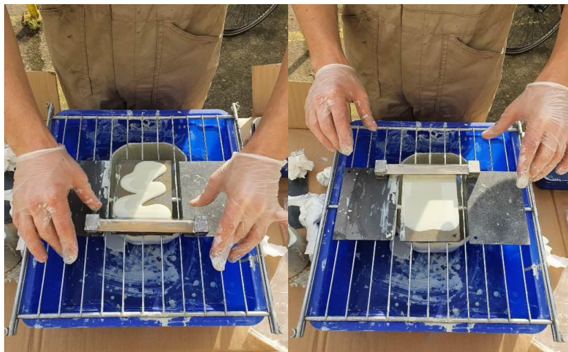
Figuur 20 Aanbrengen van verf (laag één)
