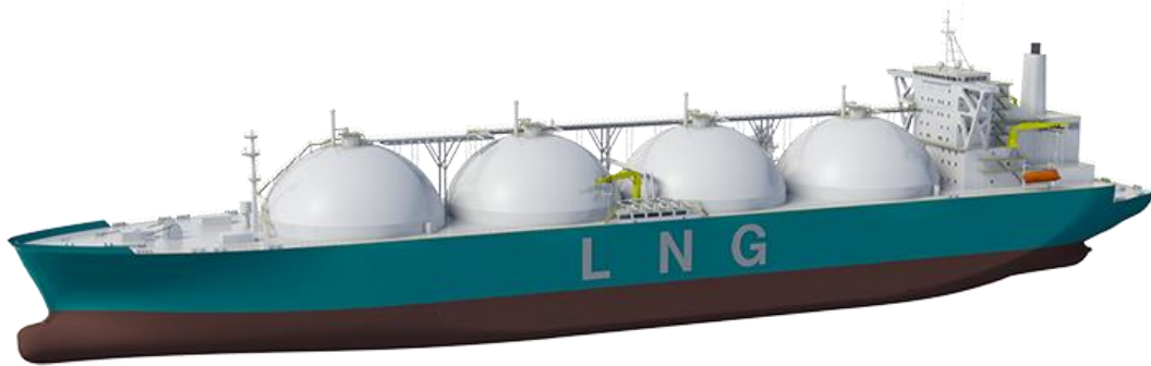
Figuur 1: LNG-schip uitgerust met ‘Moss’ tanks
