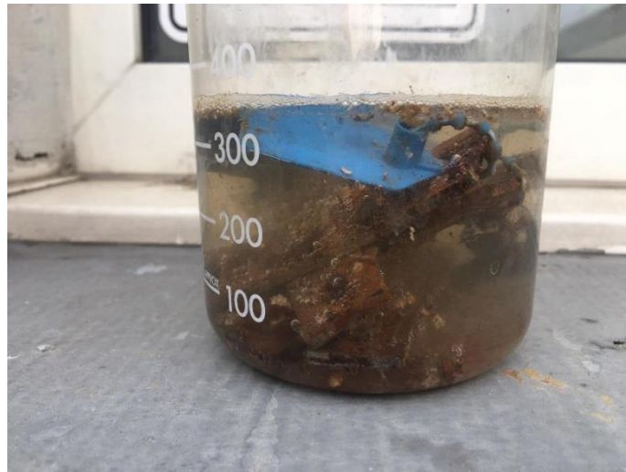
Figuur 24 Ontwikkeling van luchtbellen bij de plaatjes in de oplossing azijn
