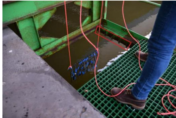
Figuur 19 Te water laten rekken
