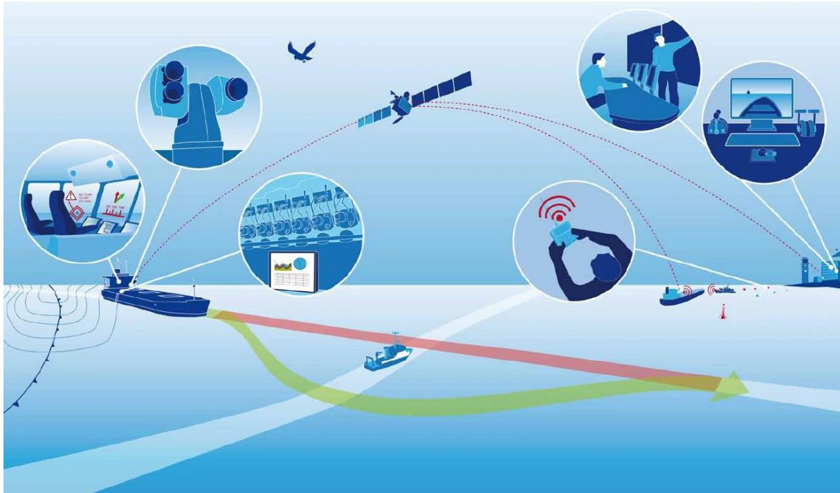
Figuur 25: Een typisch commando en control systeem van een onbemand schip
