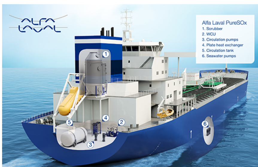
Figure 28 : Répartition des éléments du scrubber
