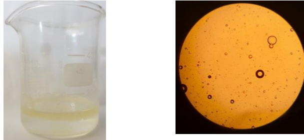
Figure 49 : Solubilité de 10% d'huile d'abrasin dans 90% d'H 2 O Source : propre travail
