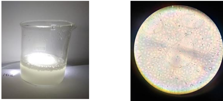
Figure 34 : Solubilité 10% d'Asconium-141S1/BG dans 90% d'H 2 O Source : propre travail
