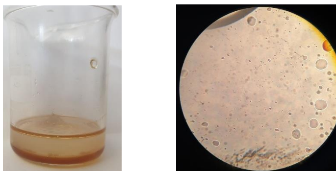
Figure 43 : Solubilité de 10% de benzothiazole dans 90% d' H_2O Source : propre travail
