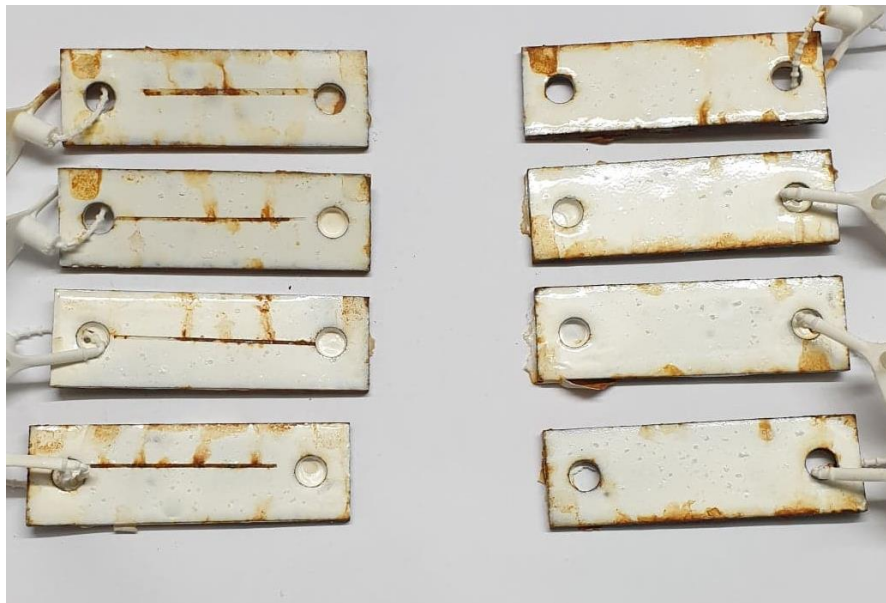
Figure 67 : Référence L après 220 heures dans un brouillard salin Source : propre travail
