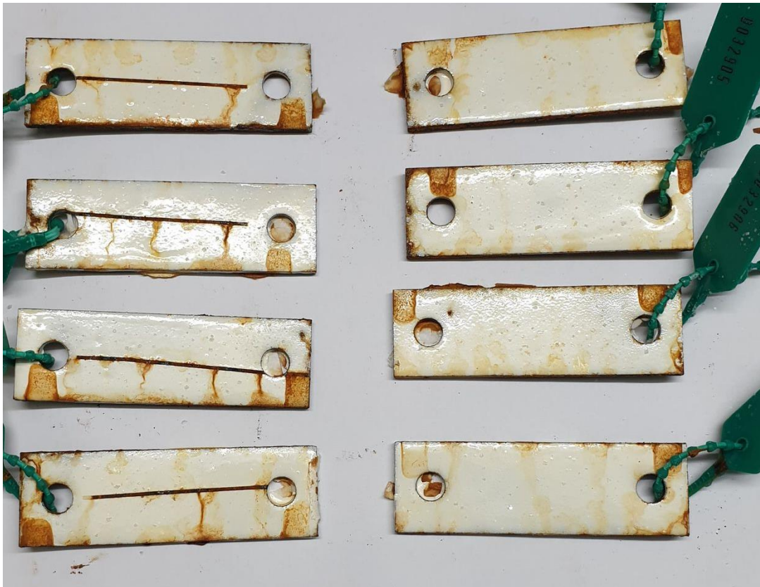
Figure 32 : Référence K après 220 heures dans un brouillard salin Source : propre travail
