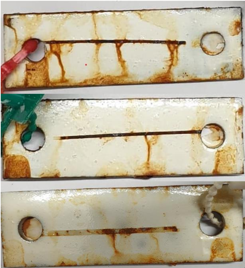
Figure 63 : Comparaison entre les références G, K et L Source : propre travail
