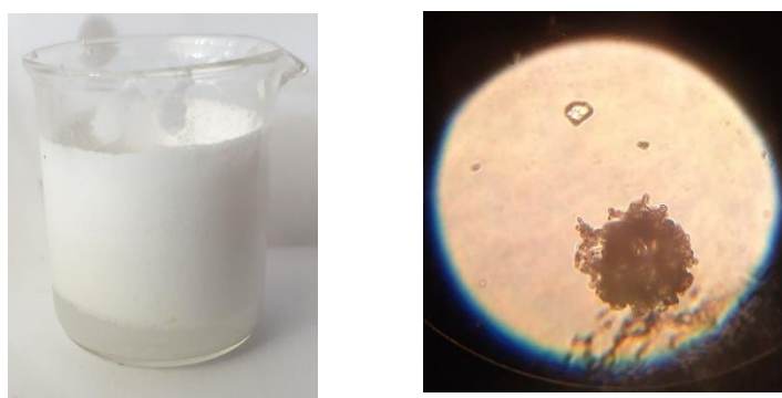
Figure 41 : Solubilité de 6% de mercaptobenzithiazole dans 8% d'éthanol et 86% d'H 2 O Source : propre travail
