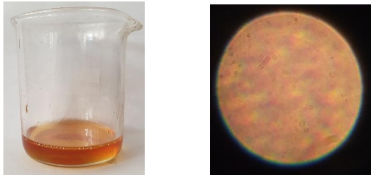
Figure 52 : Solubilité de l'Asconium-141S1/BG dans l'huile de lin Source : propre travail
