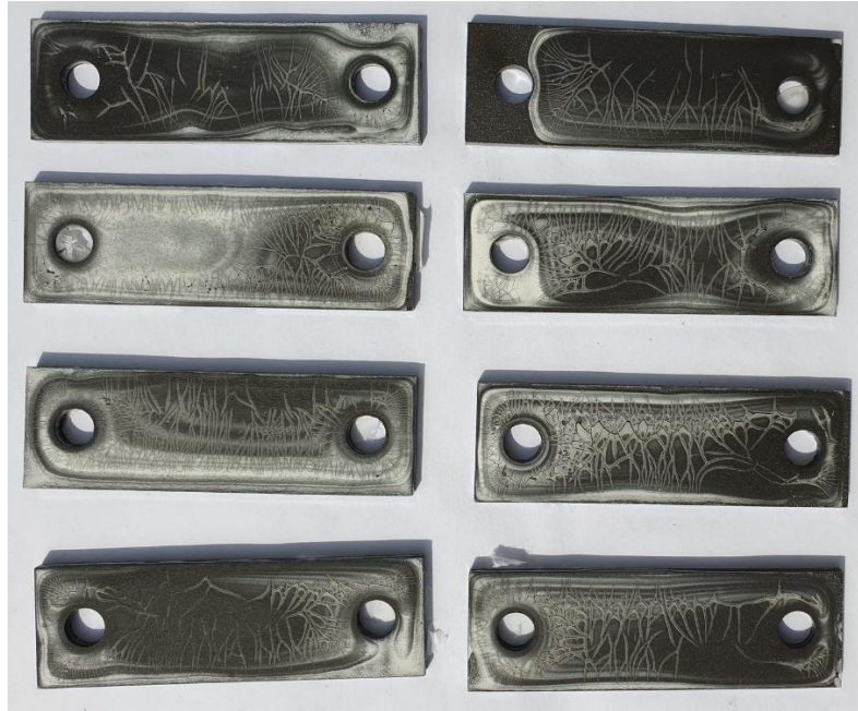
Figure 19: Référence A, phénomène de mud cracking
