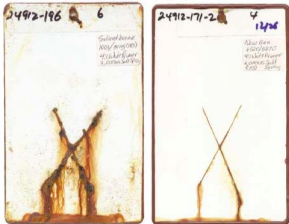
Figure 4 : Comparaison de plaques époxy à base de solvant et aqueuse après un test de 2000 h dans un brouillard salin
