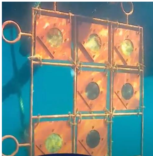
Figuur 15 Testplaatjes met en zonder antifouling
