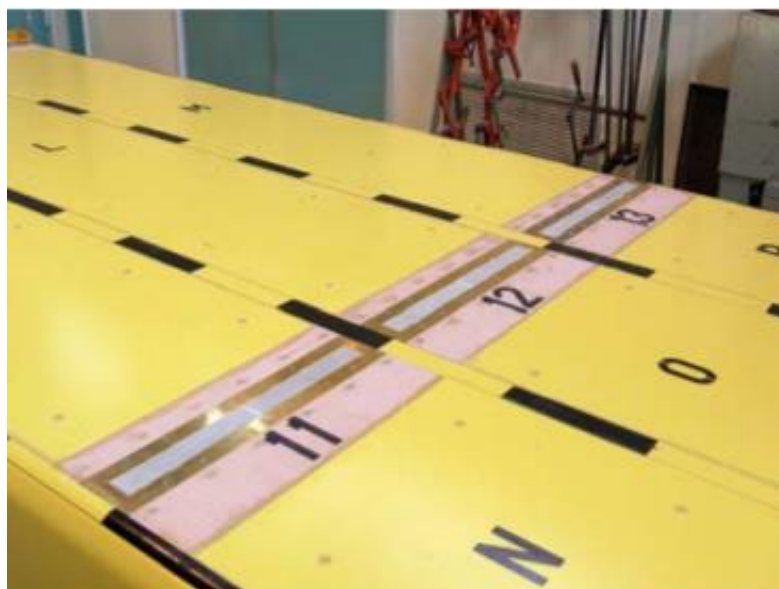
Figuur 17 Onderkant scheepsmodel met metalen strips
