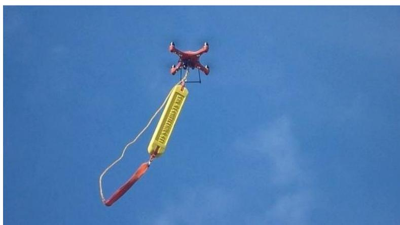
*Figure 26 : Drone transportant une bouée de sauvetage
