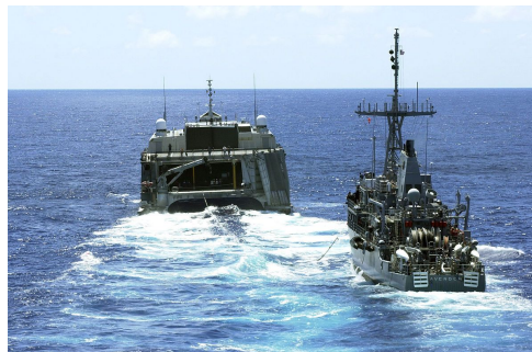
Figuur 10 Brandstof-transfer via de “Astern” methode 36
