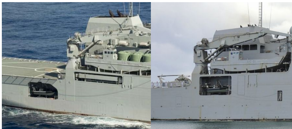
Figuur 24 (L) en 25 (R) Oude opstelling RHIB (L) en nieuwe (R) 91
