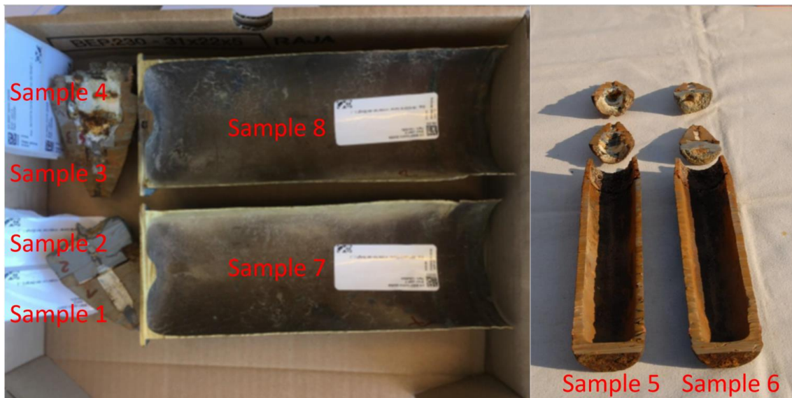
Figuur 29 Stalen DOVO: huls, granaatlichaam en ontsteking Bron: (OCAS & AMACORT, 2017)
