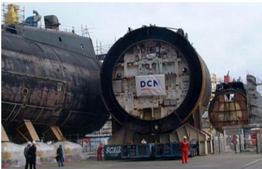
Figure 33 Extraction de la tranche réacteur d'un SNLE, avant d'être ressoudée Source : Direction Général de l'Armement Français (2016)
