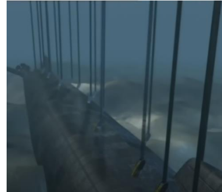
Figure 29 Installation des câbles de traction sur la coque du sous-marin. Source: Raising de the Kursk (SMIT salvage, s.d.)
