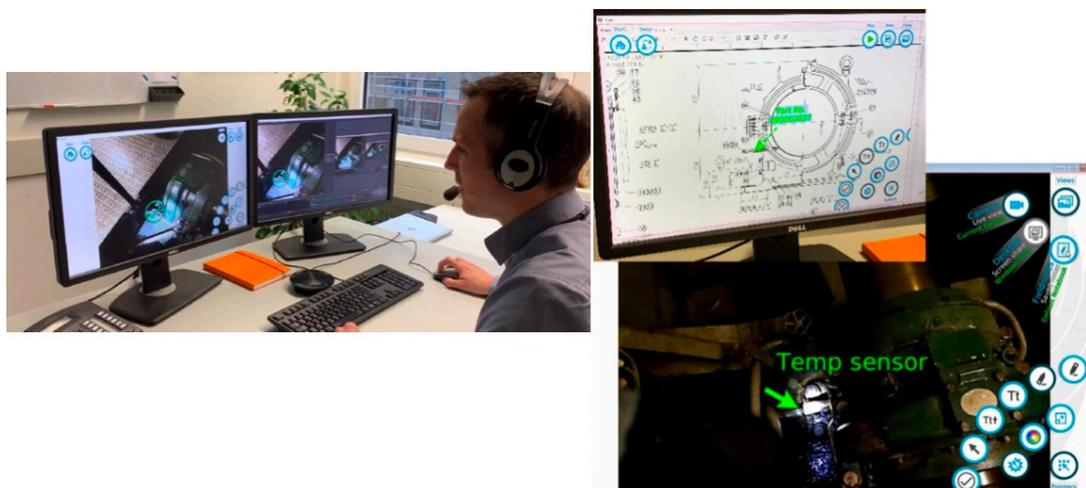
Figure 18 Système de Télé-Assistance Collaborative par Wärtsilä
