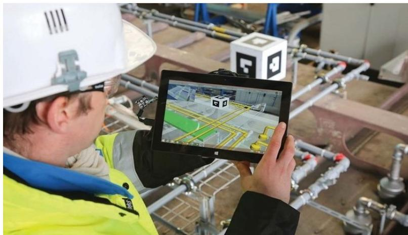
Figure 16 Vérification du réseaux de conduites d'un paquebot aux Chantiers de l'Atlantique avant le montage.
