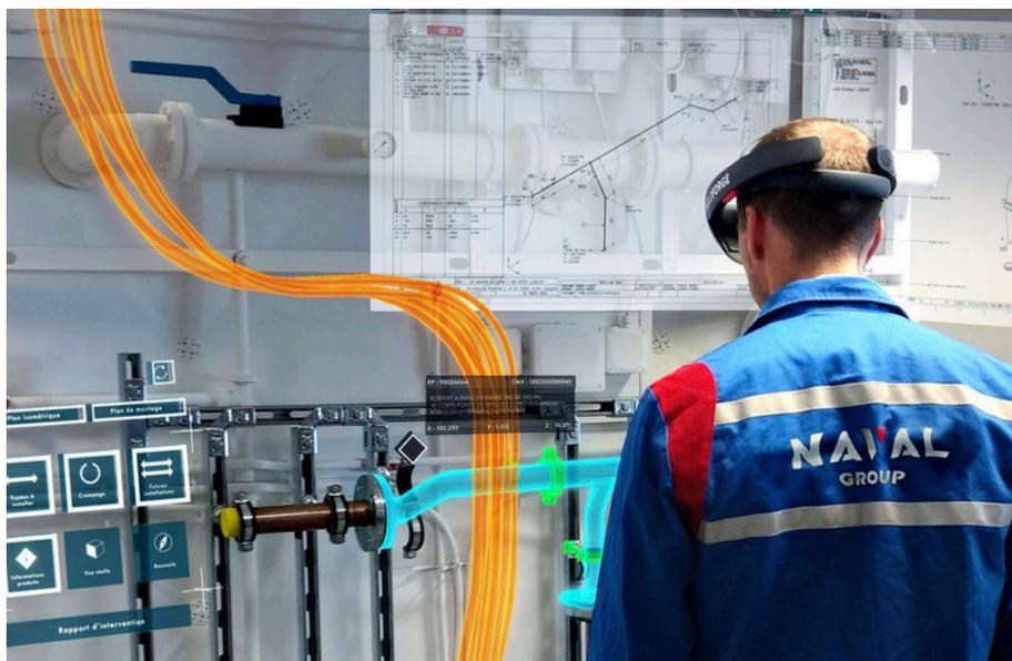
Figure 13 Aperçu de la solution de réalité augmentée pour le contrôle de la tuyauterie dans les chantiers navals de chez Naval Group
