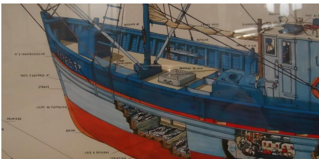
Figure 7 : Coupe de la cale d'un chalutier-thonier
